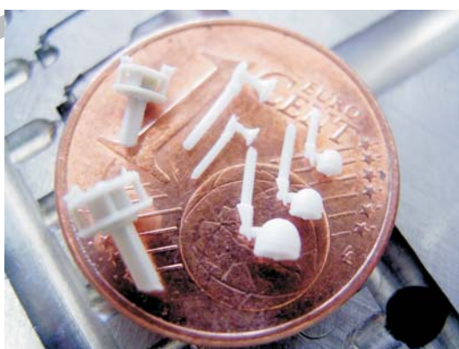
Anbauteile für Modelleisenbahn (Signalhorn 0,7 mg, Scheinwerfer, Lüfter)
